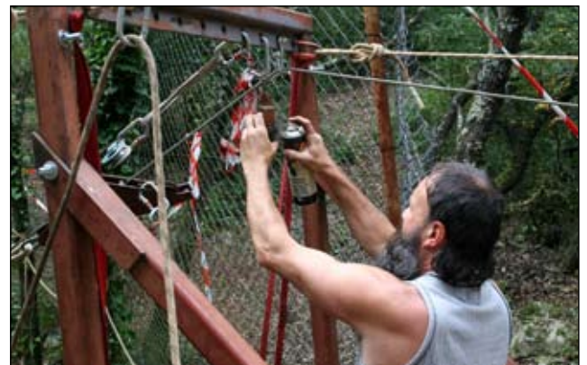
Treuil électrique alimenté en 380 V par un puissant groupe électrogène et détail du portique.
