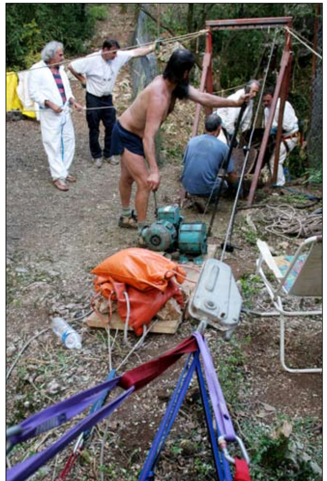
Treuil électrique alimenté en 380 V par un puissant groupe électrogène et détail du portique.
